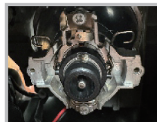
Step3:D2/D4LEDバルブを台座に差し込みスプリングで固定します。
