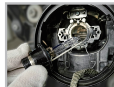
Step2:固定用スプリングを抜き、バルブを取り出してください。(火傷しない様に、バルブが冷めてから作業をしてください。)
