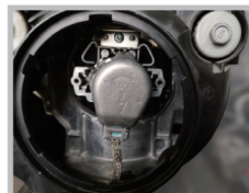
Step1:ヘッドライトレンズを取り外し、ユニット内にある純正HIDバラストのカプラーを取り外します。(日本車のはほとんどはヘッドライトレンズを取り外す必要はありません)
