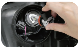
② 現車台座の位置に合わせてLEDライトを装着します。事前に付属の六角レンチを使い、バルブの台座を固定するネジを緩めておいてください。
