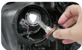
① 現車バルブの位置を確認し、ソケットを取り外し電球を外します。
