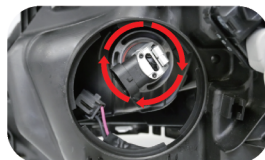
③バルブを装着したまま、先端部を回転させます。車種に合わせて最適な照明角度に調整してください。
