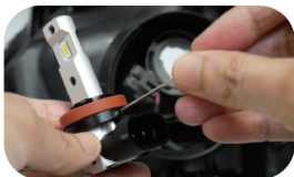
④光軸調整ができたならその六角レンチを使い、バルブの角度を固定します。 (画像のバルブは他製品ですが、取付方法は共通です。)
